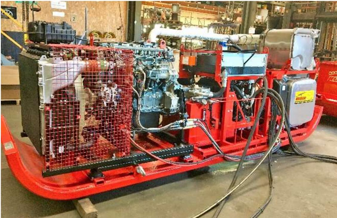
**Der Schlitten mit Dieselmotor, kompletter Hydraulik und Tank**
