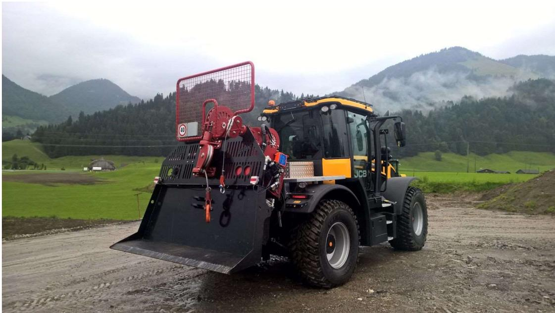
**Die Seilwinde P25hy hat 25 Tonnen Zugkraft, die Hilfsseilwinde 4 Tonnen.**
